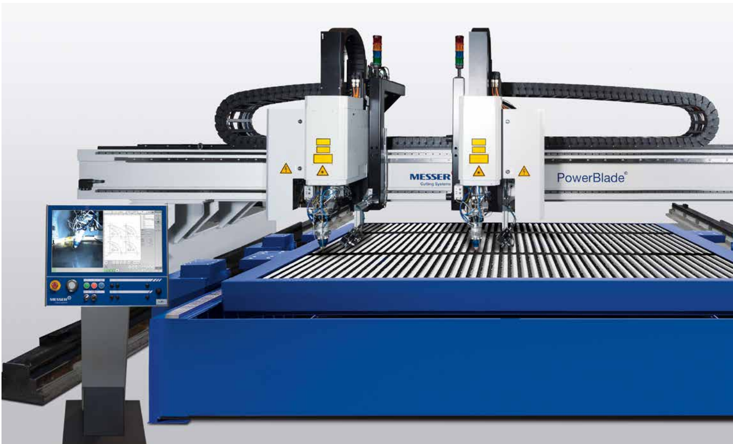
Die neue Steuerung Global Control mit 24"-Touchscreen Monitor bietet viel Platz, eine klare Bedienung und ist bei Bedarf flexibel konfigurierbar
