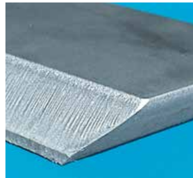
Fasenbeispiel in Baustahl: 15 mm 45° YDS und 30° VAS (Schneidqualität abhängig von Material)
