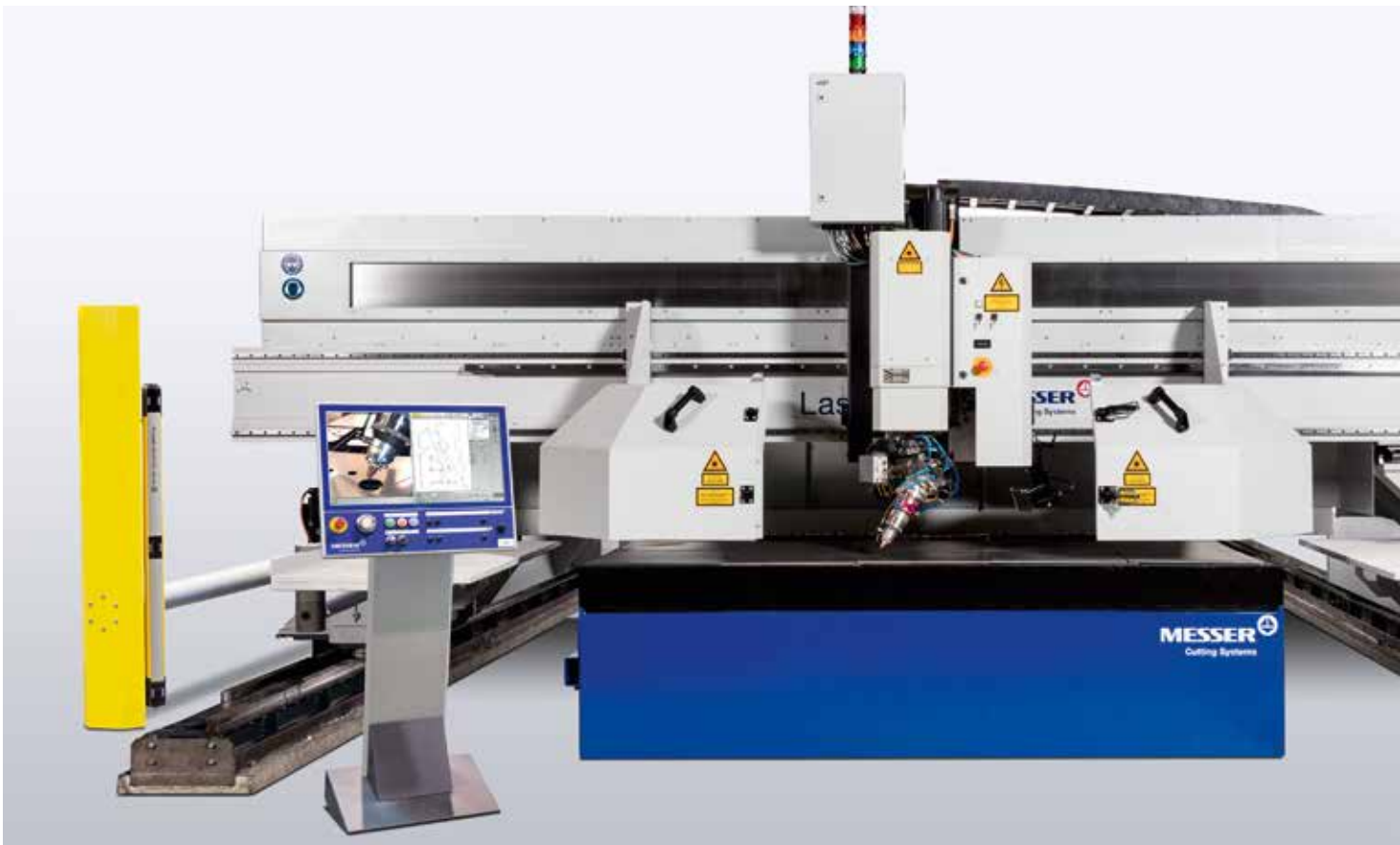
Die neue Steuerung Global Control mit 24"-Touchscreen Monitor bietet viel Platz, eine klare Bedienungsführung und ist bei Bedarf flexibel konfigurierbar
