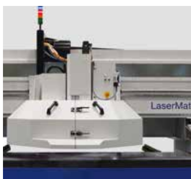
Mitfahrende Laserschutzhaube und Lichtschranken erlauben direkte Kranbeladung sowie Be- und Entladung während des Schneidbetriebs
