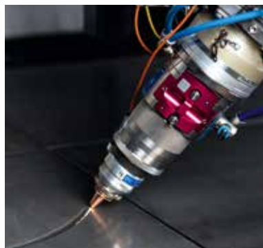
Der endlos drehbare Fasenkopf mit magnetischem Havarieschutz ermöglicht Fasenschnitte bis 50°
